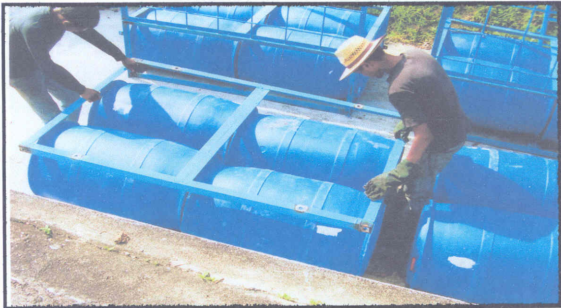
M.S Angle Iron 50mm x 50m untuk membuat frame pelampung
