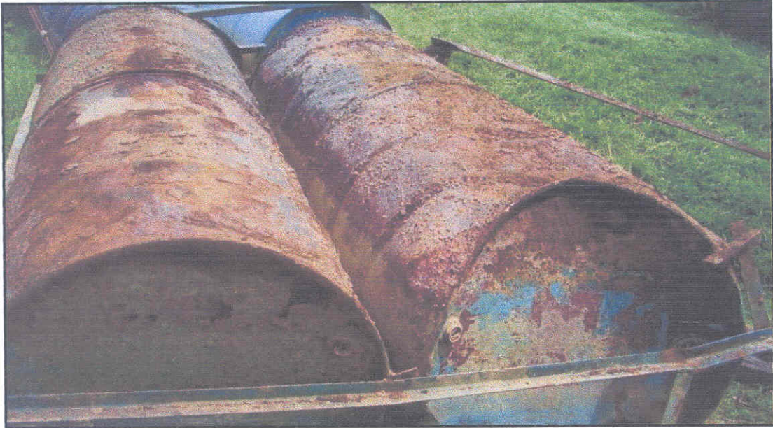
Pontoon drum yang berkarat
